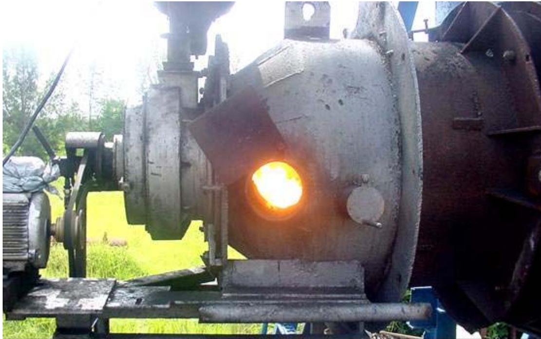
**Combustor experimental de 3 MW<sub>t</sub>, para evaluaciones con paja de caña residuos agrícolas y otras biomosas pulverizadas.**
